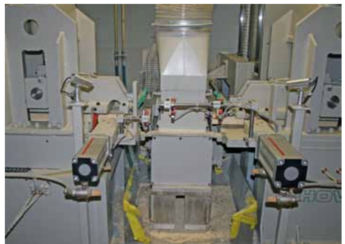
Flyback Keilzinkenautomat von Howial wurde eigens für Stuber & Cie entwickelt
